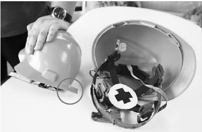
● 劣质安全帽稍为用力按一下,就开裂了(画圈处)
