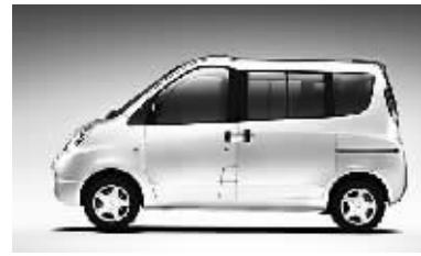
在内部布局上，瑞麒2宽敞舒适，座椅布置灵活多变，既可布置成5座与7座轿车，也可以将后两排座椅完全平折成为厢式货车。胡静
