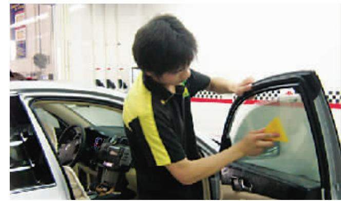
利用化石粉用于保证窗膜的防划伤层“SR”不因静电作用而吸附在玻璃上,使膜在玻璃上能充分、自由地滑动。干烤法有其独一无二的优点:速度快,一般用湿烤法需十几分钟,而干烤法大约2-3分钟就可烤好;更安全、更服帖,膜的收缩
