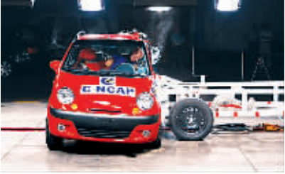
■ 可变形移动壁障侧面碰撞(雪佛兰)
