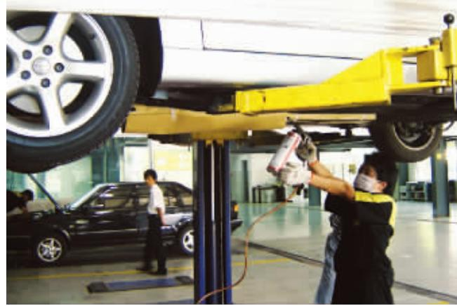
分钟，胶质物就可以凝固。待前一次的喷涂物基本干燥，再进行下一次的喷涂，这样周而复始地反复喷涂，一般车辆需要喷涂3-4遍。
