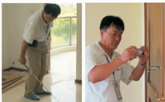
■每块地砖都要咚咚咚检测有无空鼓音 ■塞尺法检测出木门缝隙超标，立此存照
