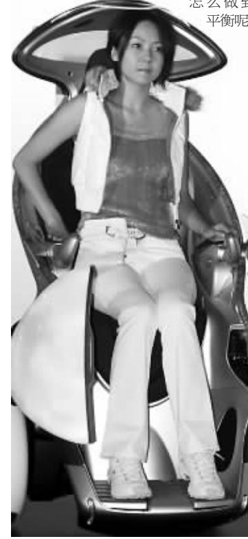
原来,i-swing采取了与著名的个人移动工具Segway类似的方式,装陀螺仪来保持平衡。一旦车身站立,陀螺传感器控制系统就自动启动,使它在原地转身就像一个人环顾四周一样自然顺畅。
