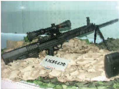
■ 5.8 毫米狙击步枪,采用小口径子弹和无枪托设计,在历次演习中,该枪都有上佳表现
