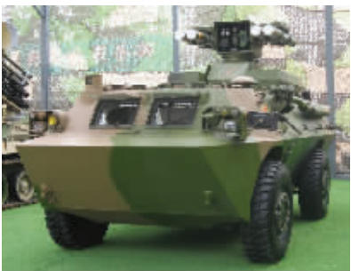
■ 能灵活摧毁敌方重装甲目标的国产反坦克导弹发射车,该车能在1分钟内发射8枚导弹
