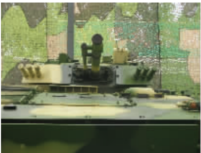
■ 战车的光学观瞄装备既有先进的热成像仪也有用于压制敌方观瞄装置的激光压制系统
