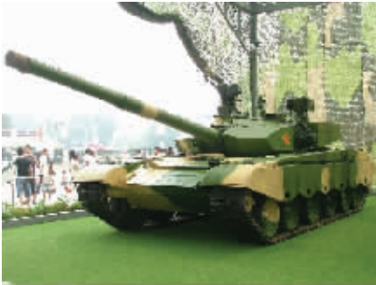
■ 最新主战坦克的炮塔采用扁平楔角造型
