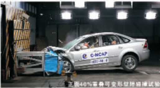
正面40%重叠可变形壁障碰撞试验
