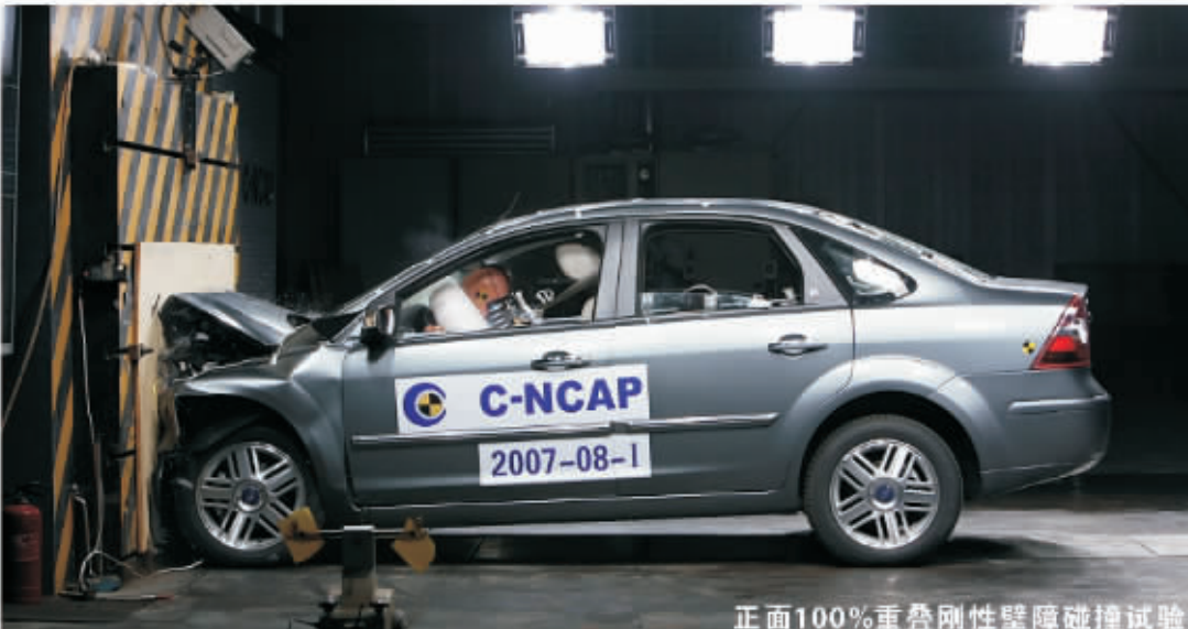
正面100%重叠刚性壁障碰撞试验
