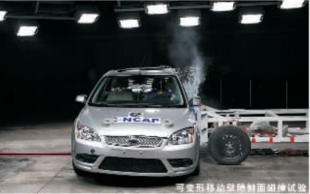
可变形移动壁障侧面碰撞试验
