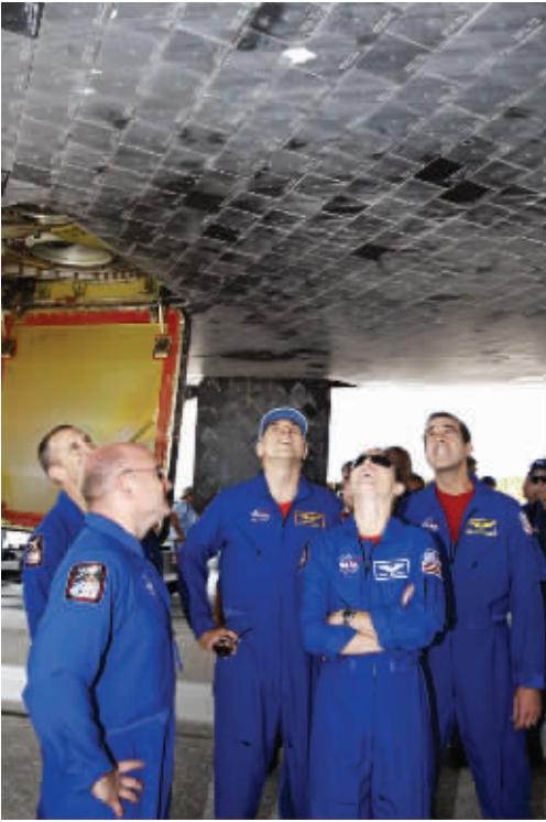
■工作人员察看机腹破损的隔热板
