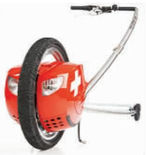
形形色色的三轮车,在很多国家的城市都作为机动灵活的交通工具,将其提供给纷至沓来的观光客。而瑞士生产的新型三轮车 X6 Easy-Glider,则给人们提供了又一种方便好玩的选择,对于骑车上班的人们就可以多了一个交通工具啦!这款名为 X6 Easy-Glider 的三轮车,荣获国际运动器材大展 ISPO 的大奖,它依靠电能工作,没有任何污染排放和噪音,更为神奇的是它的节能妙招:每当你下坡或刹车的时候,多余的动能将转化为电能储存在蓄电池里!驾驶着它行驶时,人在后面站立,而手只要握住方向杆即可随时调节快慢、方向和刹车,端的是操控自如,远远看去,脚踩着它像是滑水般行驶在车水马龙的公路上。据报道,X6的时速约为12mph(约每小时20公里),最高可达16mph(约每小时26公里)。它的电池是充电式的,每次充电时间为6-8小时,续航力约为15-20公里。该车还附有带扬声器的MP3随身听、可更换式样新潮的换挡器以及太阳能充电装置等,可以说是“麻雀虽小、五脏俱全”了。刘民放
