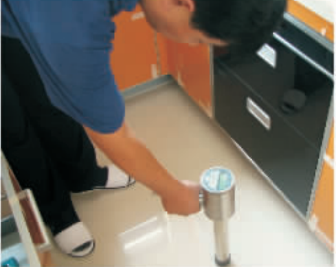
■用智能辐射仪检测地铺有无辐射污染
