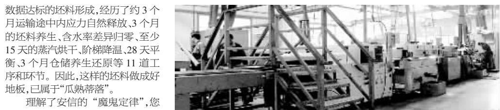
数据达标的坯料形成，经历了约3个月运输途中内应力自然释放、3个月的坯料养生、含水率差异归零、至少15天的蒸汽烘干、阶梯降湿、28天平衡、3个月仓储养生还原等11道工序和环节。因此，这样的坯料做成好地板，已属于“瓜熟蒂落”。
