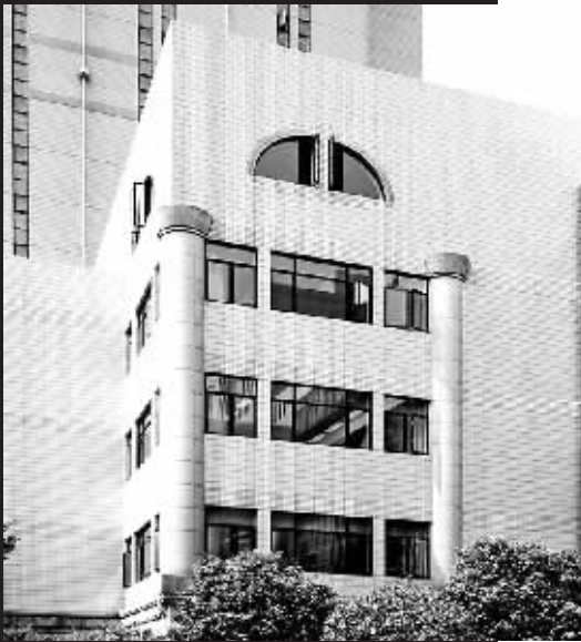
■同样是柱，建筑师也将它作了壁柱和廊柱的不同表现处理
