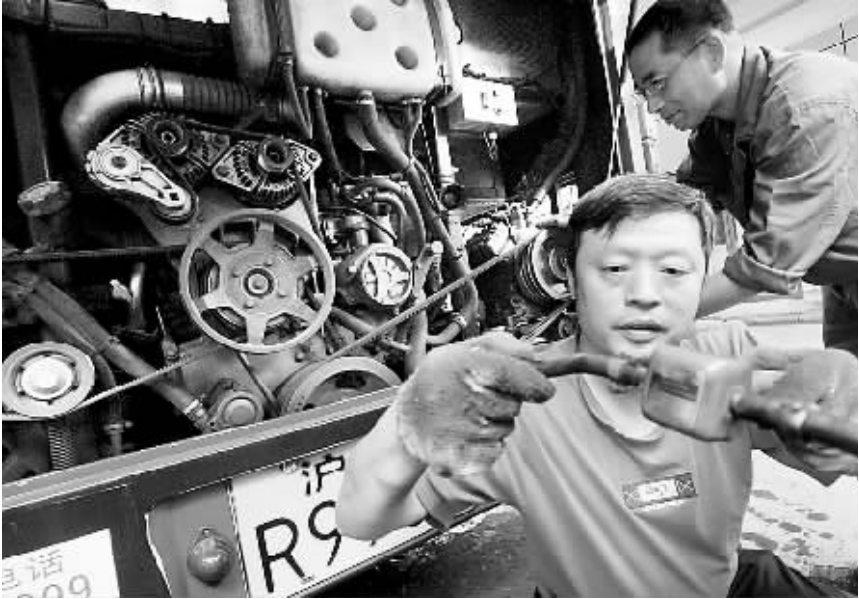
为减少公交车尾气排放冒黑烟,申新巴士南浦车队职工开动脑筋,在部分公交车上率先安装了“节油净化器”,使油耗降低 5%,既有效节能,又降低了尾气排放。 图为职工在安装“节油净化器” 杨建正 摄影报道
