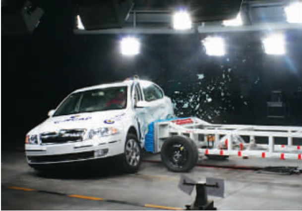
斯柯达明锐正在接受可变形移动壁障侧面碰撞测试
