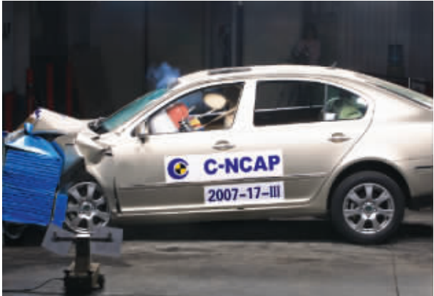
斯柯达明锐正在接受正面40%重叠可变形壁障碰撞测试
