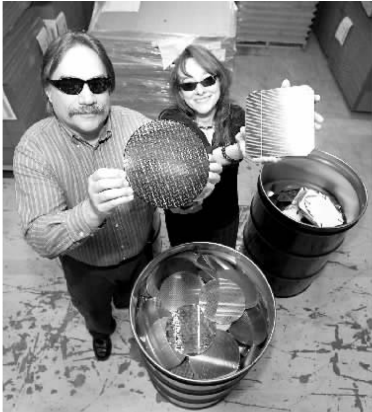
■ IBM 芯片制造项目经理詹姆士拿着半导体硅晶片(圆形),制造工程师米雪儿拿着用其制成的太阳能电池板(方形)。
