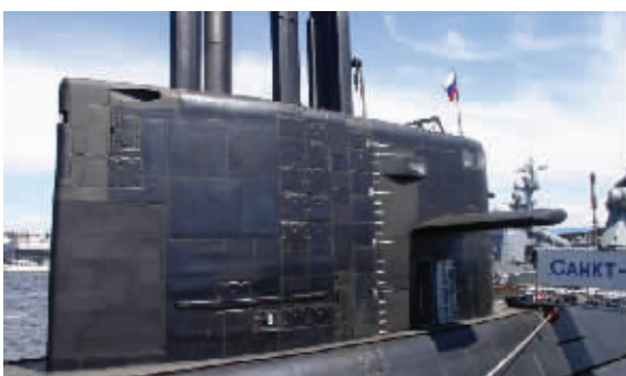
潜艇艇身上贴满阻塞噪音传播的消音瓦
