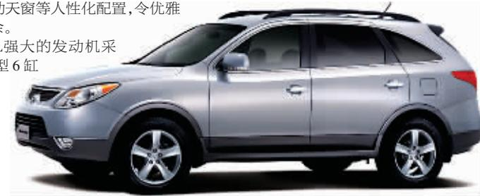
CVVT+DOHC技术，提供达到191kW/6000rpm的最大功率，以及348N·m/4500rpm的峰值扭矩，搭配Aisin阶梯式6速手自一体变速器，同时配备了电子可调悬架系统、电子控制智能适时4轮驱动系统。
