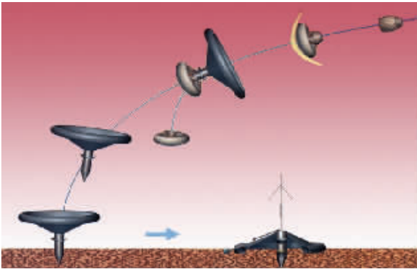
探测器降落火星表面的示意图 执行气象探测任务的MetNet着陆
