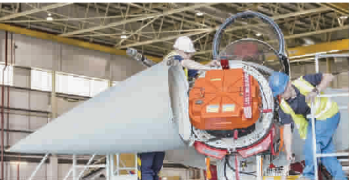
■ 欧洲战斗机公司的工程师在“台风”战机的机鼻内安装“追捕者-E”雷达
