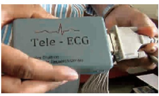
信用卡大小的心电图机 Tele-ECG
