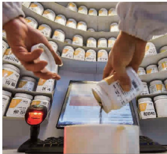
童涵春堂的中药配方颗粒采用电子称重，误差在0.2毫克以内
