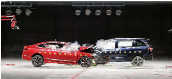
可以进行不同级别、不同尺寸的车型间各种角度的碰撞试验。
