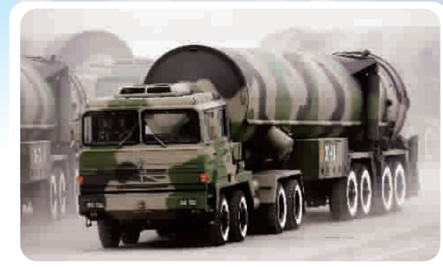
▲中国新型洲际弹道导弹的两种机动构型,左为牵引拖车底盘,下为自行越野车辆底盘。就战场生存力而言,采用越野底盘的自行式洲际弹道发射车更具优势,它能进行无依托发射(即发射阵地不需要预先准备),车辆在机动过程中可随时停车发射 东方IC
