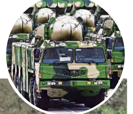
▼东风-21D反舰弹道导弹是火箭军的明星武器。与常规弹道导弹相比,东风-21D的弹头具有末端制导能力,通过持续更新目标参数,能准确命中海上移动目标。其实,东风-21D不只是一枚导弹,它包含侦察、通信、指挥、作战等多个系统,通过体系对抗发挥威力 解放军画报
