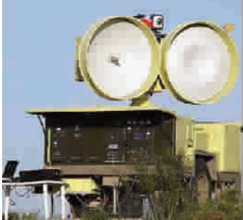
伊朗在 MPQ-46 雷达基础上为“梅尔萨德”系统研制的照射雷达
