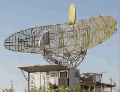
伊朗在 MPQ-50 雷达基础上为“梅尔萨德”系统研制的对空脉冲搜索雷达
