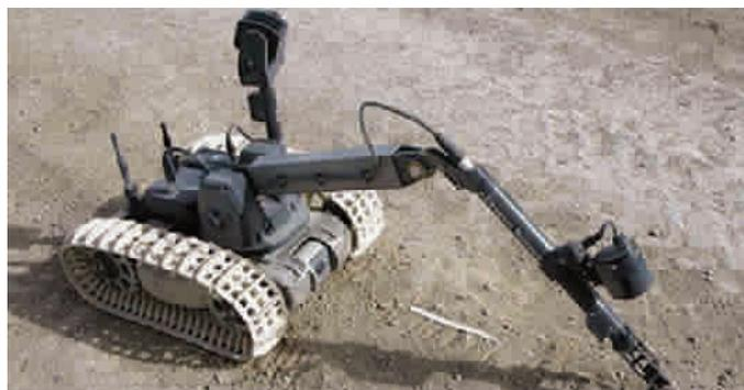
鉴于恐怖分子经常利用简易爆炸装置制造公共伤亡事件,英国空军拆弹部队也未雨绸缪地为奥运会准备了名为“龙行者”的高科技拆弹机器人(如上图)。这款由奎奈蒂克公司研制的机器人可以放进军用背包内,非常方便实用。
