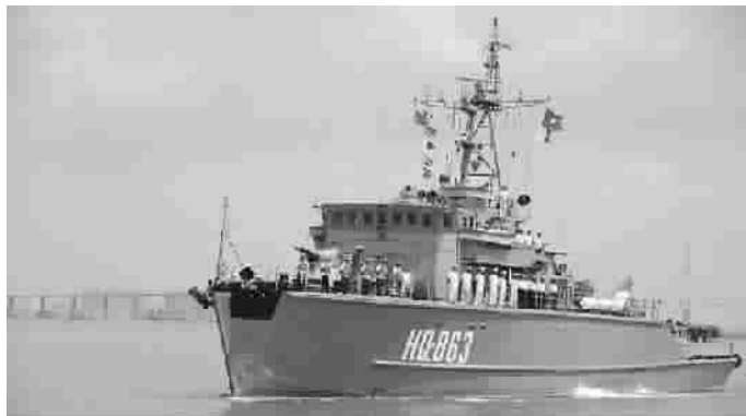
■ 越南海军扫雷艇,该艇长49米,宽8.8米,满载排水量430吨
