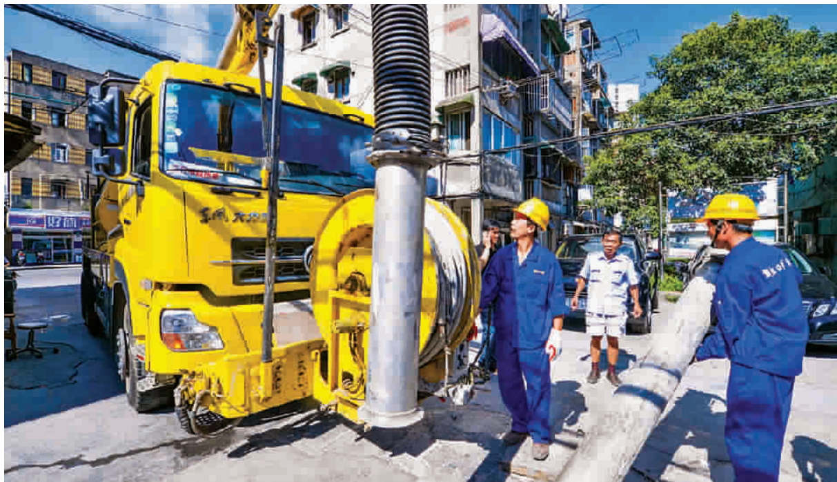
■ 多功能联合吸污车成为排水部门疏通下水管道的利器
