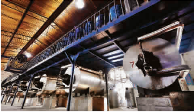
■ 12 组废弃物三相分离处理一体化设备,可以将餐厨垃圾烘干分离
