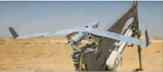
“扫描鹰”无人机可由名为“超级楔”的弹射装置发射升空
