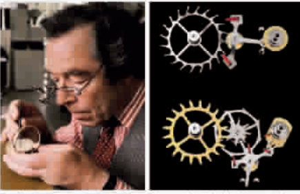
制表大师: 乔治·丹尼尔 上图: 瑞士杠杆擒纵系统, 下图: 2500机芯中装置的同轴擒纵系统
