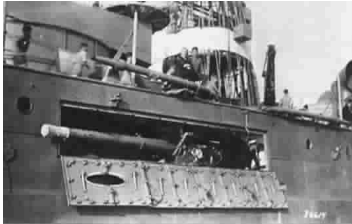
“Q船”上的火炮和鱼雷发射管被隐藏在下层甲板,炮位外用钢板掩蔽
