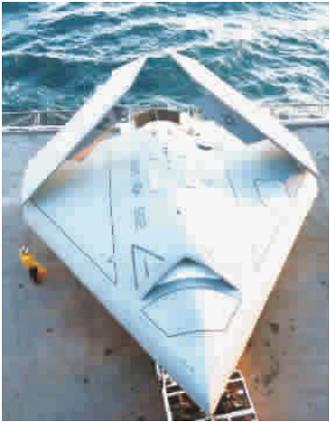
■ X-47B 配备了折叠机翼和 2 个内部弹舱,最大起飞重量达到 20215 千克
