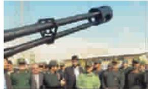
据《简氏防务周刊》报道,伊朗正在研制名为“阿瑟菲”(Arsefeh)的23毫米口径3管加特林自动炮,用于对付巡航导弹。据称,“阿瑟菲”自动炮的射速达到每分钟900发。这也是伊朗首次尝试研制加特林转管自动炮。
