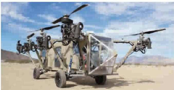
度,从而使速度进一步加快。而以卡车模式行驶时,所有的旋翼发动机都会折叠收拢,大大减小车辆宽度,以便穿越狭窄的街道。
