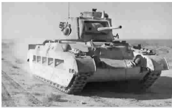
■ 二战期间,英军马蒂尔达-2型坦克主要部位的装甲厚度达到78毫米
