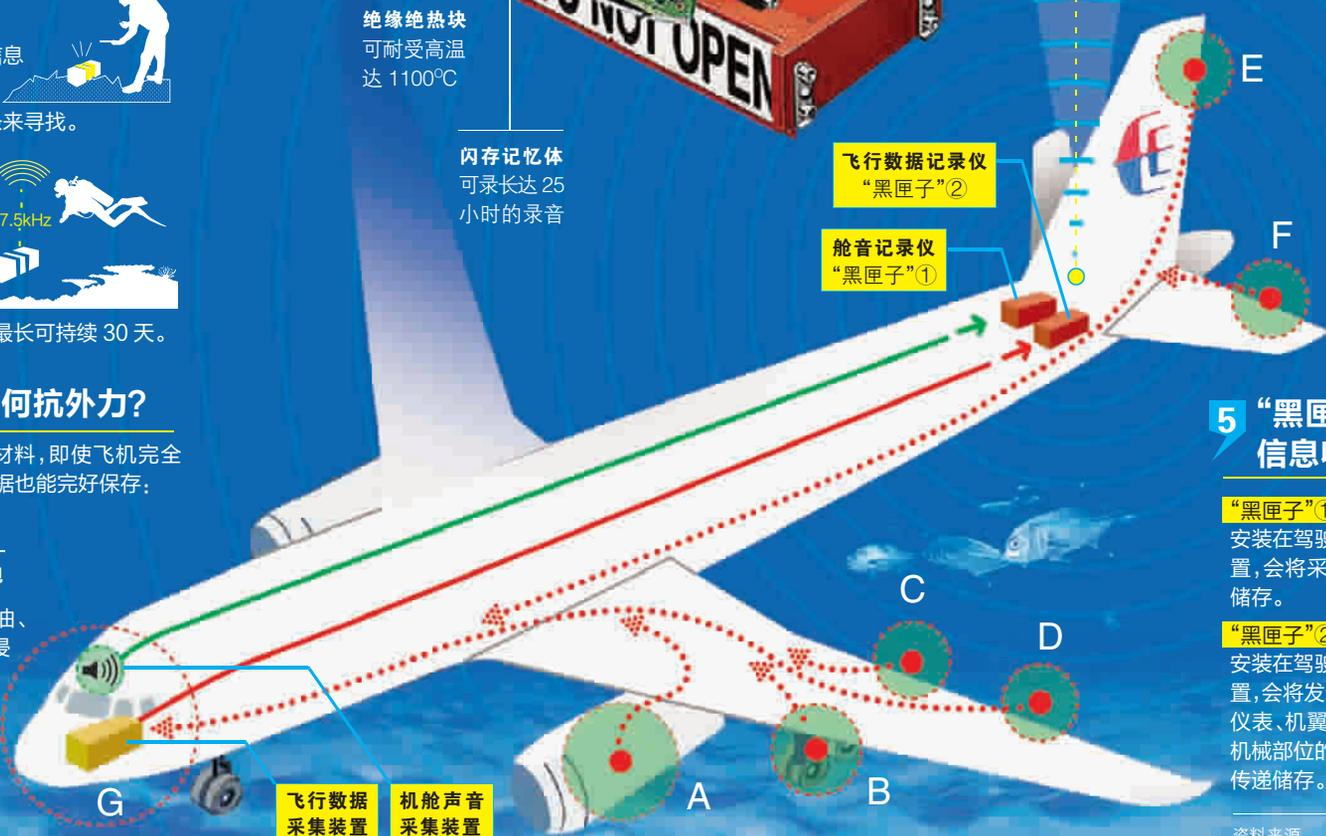
◆ “黑匣子”一旦落入海里，定位信标器可从深达 6000 米的水下，每秒发送一次超声波脉冲信号。
