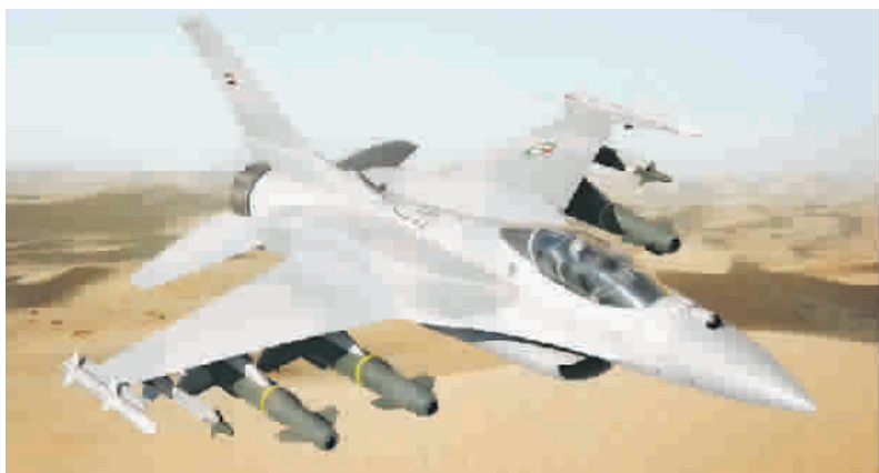
阿联酋购买的美制F-16E战斗机加装保形油箱，大大增加航程和作战半径
