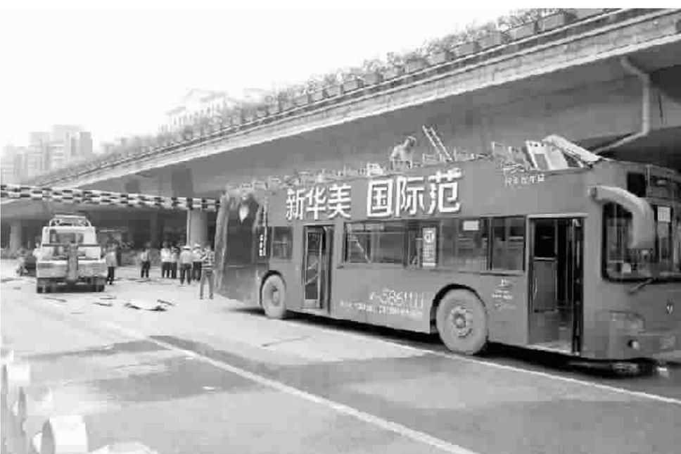
记者从广西南宁市宣传部了解到,昨日上午11时左右,一辆车牌为桂A67222的701路双层公交车行驶至竹溪大道青竹立交桥底时,与桥架限高防控架相刷,造成双层公交车顶脱落(见图),导致车上乘客28人受伤,无人死亡。据了解,事发车辆属广西运德汽车运输集团有限公司邕宁公交公司所有。目前,肇事驾驶员已被公安部门控制,安监部门已启动事故调查工作。
