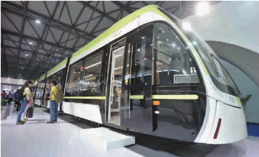
中国南车世界首创的超级电容 100%低地板有轨电车,车门台阶距地面仅 33 厘米
