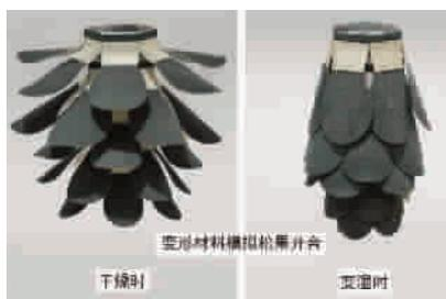
通过多层粘合, 他试制了一种多层板, 由纤维、薄膜和薄板层层粘成。上面这些材料对水都有反应, 不过程度不同。一旦变潮, 纤维吸水后横向扩大, 造成材料被拉伸而弯曲, 这就像松果的收拢。
