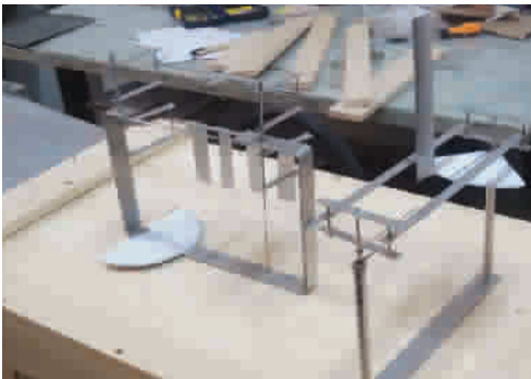
■ 复原后的莱特兄弟的升力/阻力天平 童纪 摄
