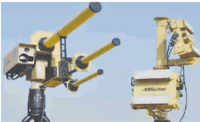
■ 3家英国企业联合研制的AUSS系统能定向发射干扰信号使无人机瘫痪
