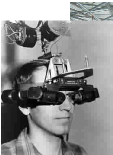
▲伊万·萨瑟兰博士于1968年发明的世界第一台虚拟现实显示设备“达摩克利斯之剑”,由于分量过重,该设备只能镶嵌在天花板上(资料照片)
