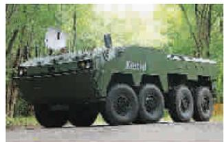
在3月28日举行的2016年印度防务展上,印度塔塔汽车公司展出了一款改进型“茶隼”8x8装甲战车。该车配备俄制BMP-2战车的基础炮塔,配备武器包括1门2A42式机关炮(口径30毫米)、1挺PKT式并列机枪(口径7.62毫米)、6具烟幕弹发射器,以及配套瞄准系统。
