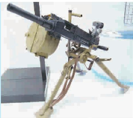
安装的主体部分重16千克，容弹量30发的金属弹鼓重13.7千克，使用时弹鼓会钩挂在机匣右侧，榴弹发射器长840毫米（发射管长290毫米），发射管口径30毫米，初速185米/秒，射程1700米，每分钟可发射
