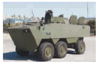
韩国陆军已经向韩国现代集团订购了600辆轮式装甲车，计划从今年年底开始交付，2023年交付完毕。这批车辆以8x8驱动的K808型装甲车为主，同时也包括6x6驱动的K806型装甲车（如图）。K808型车重约20吨，可搭载12人（乘员2人、载员10人），装备30毫米自动火炮和7.62毫米机枪，公路行驶最高速度110千米/小时，涉水行驶最高速度10千米/小时。K806型车重约16吨，主要用于侦察和国内治安，也能搭载12人，装备有40毫米自动榴弹发射器和机枪。据悉，这两型装甲车的研制工作始于2012年，当时韩国军方要求研制一款类似于美国“斯特赖克”的轮式装甲车。
