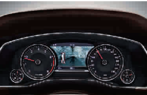
▲ 红外线夜视成像系统敏锐捕捉前方热源
