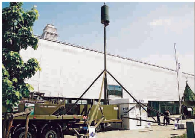
机动型“维拉-E”反隐雷达信号接收站的被动接收天线竖起
